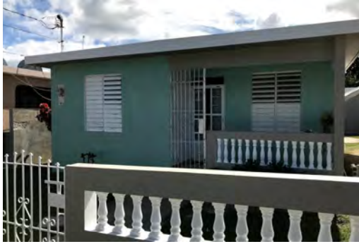
Casa de 1 piso hecha de bloques / pórticos de concreto
