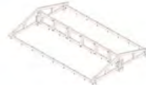
Estructura de madera anclada mecánicamente o con epoxy estructural a los muros de carga
